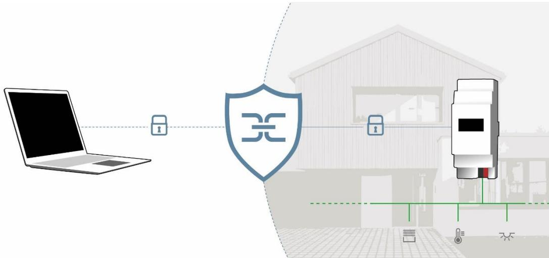
Además de reducir la posibilidad de contagios al minimizar el contacto físico entre clientes y operarios, el nuevo IPS-Remote de JUNG supone un plus de rentabilidad para instaladores y constructores, ya que proporciona una herramienta segura para el mantenimiento y la programación a distancia de todos los componentes de un sistema KNX, evitando desplazamientos innecesarios.
