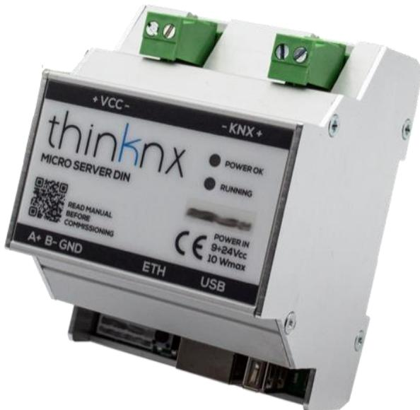
Con comunicación KNX nativa, permite la gestión de clientes ilimitados y admite grupos KNX ilimitados. El servidor también se puede utilizar como interfaz KNXnet/IP o router KNX/IP. El dispositivo proporciona integración con video porteros IP, sistemas Lutron, control de voz, IFTTT y comunicación con sistemas de terceros. Se puede utilizar un puerto USB para el almacenamiento local de registros y recopilación de datos.
